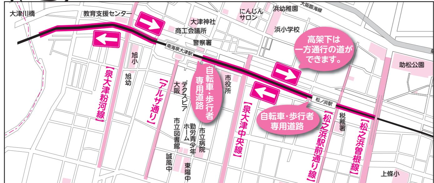
南海本線連続立体交差事業について、8月4日の始発から踏切がなくなり、東西方向の往来がスムーズになつたと思います。現在は、踏切施設の除去、電車が地上を走っていたときの線路設備などの撤去工事を行っています。その後は、泉大津駅舎、松ノ浜駅舎の仕上げ工事、泉大津駅前ペデストリアンデッキの復旧工事、側道整備に伴うインターフラワーなどが続きます。整備される側道は一方通行となり、電車と同じ進行方向となります。また、泉大津駅、松ノ浜駅の東側の側道の一部には、10m幅の自転車歩行者の専用道路が整備されます。本工事が完了するまでには、まだまだ迷惑をお掛けしますがご理解、ご協力をよろしくお願いします。
