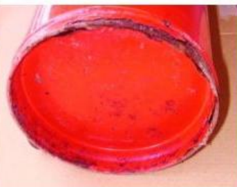
底部が錆びたもの
