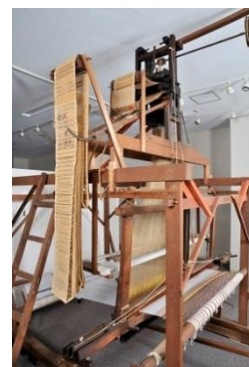
写真 2-26 三丁杼変換装置付木製手織機 (泉大津ふるさと文化遺産)
