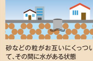
出典：財団法人消防科学総合センター 東日本大震災 液状化により浮き上がったマンホール被害の様子
